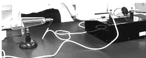
図1 実験装置(クルックス管と誘導コイル)
