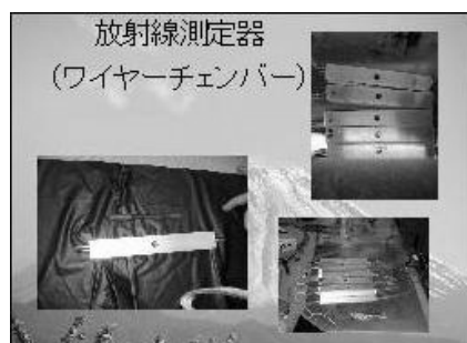
「写真 1. 工作したワイヤーチェンバー」
