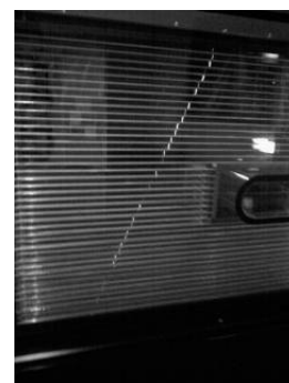
「写真 3. 放電中の放電箱」
